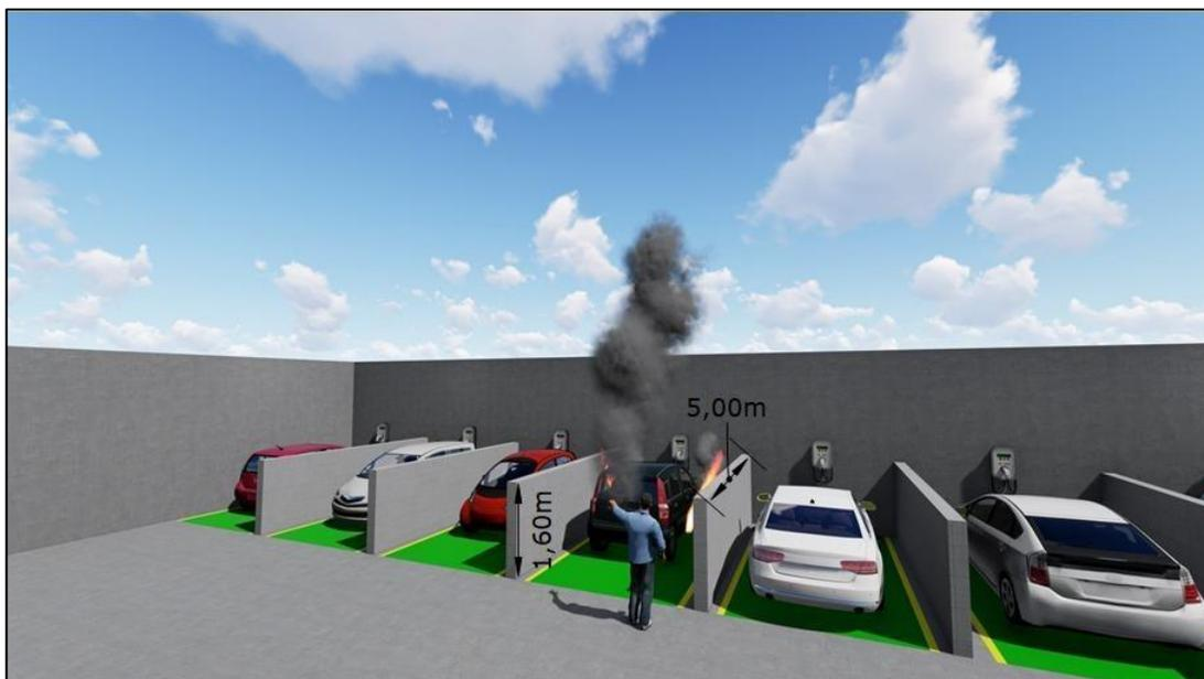
*Altura mínima das barreiras de isolamento (parede corta fogo) de 1,60 metro*
